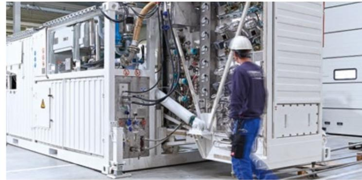
Der Rohstoff für die Luftzerlegung ist die Umgebungsluft mit ihren Hauptbestandteilen Stickstoff, Sauerstoff und Argon. Die Luftzerlegung basiert auf dem kryogenen Rektifikationsprozess, bei dem die Luft auf bis zu  $-195^{\circ}\text{C}$  abgekühlt und teilweise verflüssigt wird. Bei der Rektifikation trennen sich die einzelnen Luftbestandteile aufgrund ihrer unterschiedlichen Siedepunkte. Danach sind die Gase / Flüssigkeiten in höchster Reinheit verfügbar.
