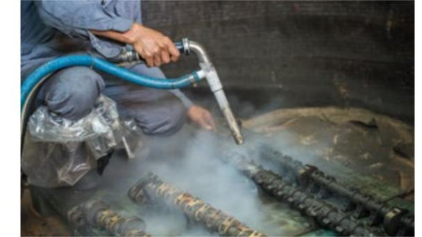
CO<sub>2</sub>-Trockeneis eignet sich hervorragend als Strahlmittel in der Industrie. Hiermit können zum Beispiel Oberflächen schonend gereinigt werden. Dieses minimal abrasive Verfahren ist äußerst umweltschonend, da auf Chemikalien verzichtet wird.
