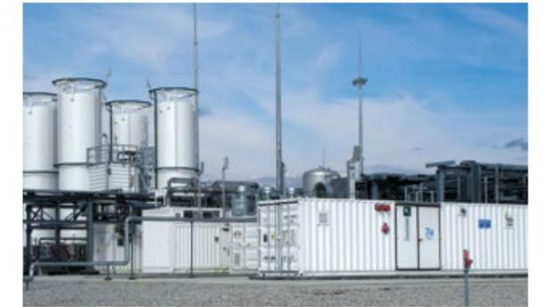
Diese Technologie von CRYOTEC ermöglicht es, auch kleinere Erdgasquellen wirtschaftlich zu erschließen und zu betreiben. Für den Transport an den Bestimmungsort wird das Erdgas mithilfe dieses Verfahrens direkt an der Quelle oder an der Pipeline gereinigt, getrocknet und verflüssigt.
