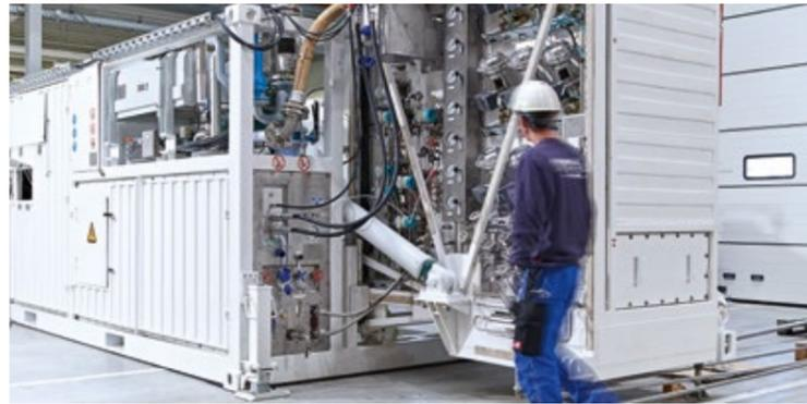
Исходным материалом для разделения воздуха является воздух окружающей среды с её главными компонентами азотом, кислородом и аргоном. Разделение воздуха базируется на процессе криогенной ректификации, в котором сжатый воздух охлаждается до  $-195^{\circ}\text{C}$  и частично сжижается. В процессе ректификации происходит разделение отдельных составляющих воздуха вследствие различных точек кипения. В результате этого получают газы/жидкости самой высокой чистоты.
