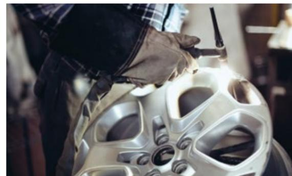
Кислород, азот и аргон играют важную роль в металлообрабатывающей промышленности. Кислород используется преимущественно при автогенной, огневой и лазерной сварке, а также в процессах плавления. Азот находит своё применение в процессах светлого отжига, и в жидком состоянии — в технологиях усадки. Аргон применяется в основном в качестве инертного газа при сварке и в металлургических технологиях.
